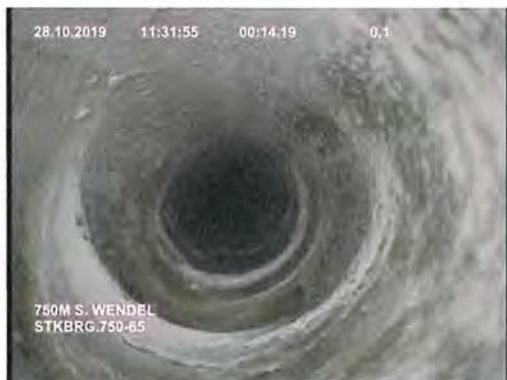
Bild 83: Konturnahe Auflockerung bis 20 cm (StKBrg.750-65, Teufe: 0,05 m)
